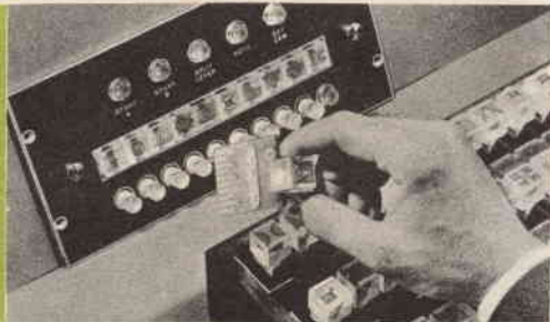
Con questo generatore di effetti speciali della RCA si possono ottenere fino a 154 effetti diversi; è uno dei più perfezionati modelli che siano stati prodotti ed usa elementi intercambiabili ed inseribili che comandano la successione di segnali dell'amplificatore di commutazione.
