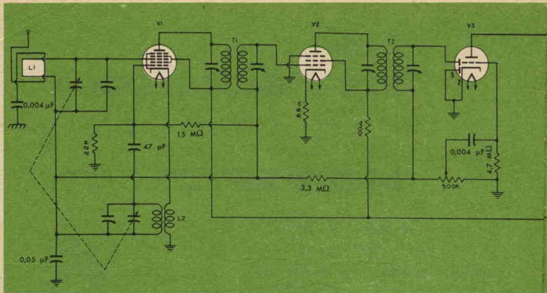
Fig. 1 - Schema di un normale ricevitore con filamenti in serie. Da circa venti anni questo circuito è rimasto virtualmente invariato. Il condensatore e il resistore in parallelo nella pagina a lato compongono il circuito d'isolamento di massa descritto nel testo.
