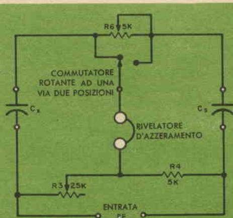
Fig. 4 - Un ponte di facile realizzazione con il quale è possibile ottenere una grande precisione.
