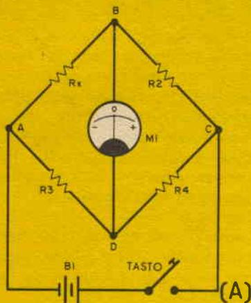
Fig. 1 - Il circuito base del ponte di Wheatstone (A) viene convertito in ponte RC (B) mediante le modifiche e sostituzioni illustrate.
