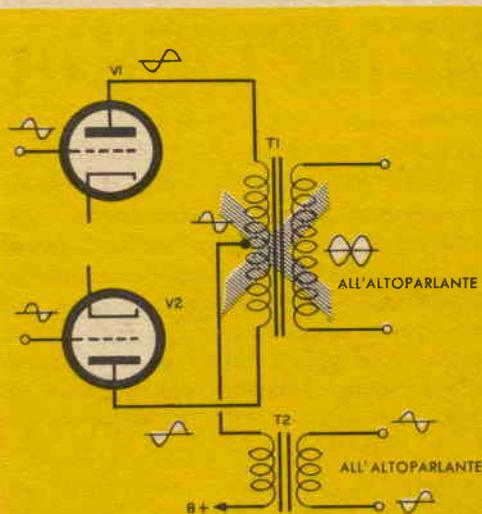
Fig. 2 - Le tensioni di segnale in fase applicate alle griglie dei tubi finali faranno sì che una tensione di segnale sia presente ai capi di T 2 ma non di T 1.
