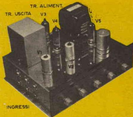
Fig. 2 - Disposizione dei componenti sul telaio.
