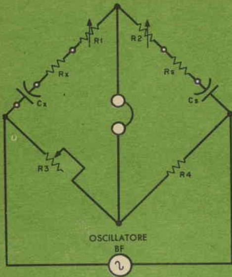
Fig. 3 - Circuito teorico di un ponte RC con vari controlli di compensazione.
