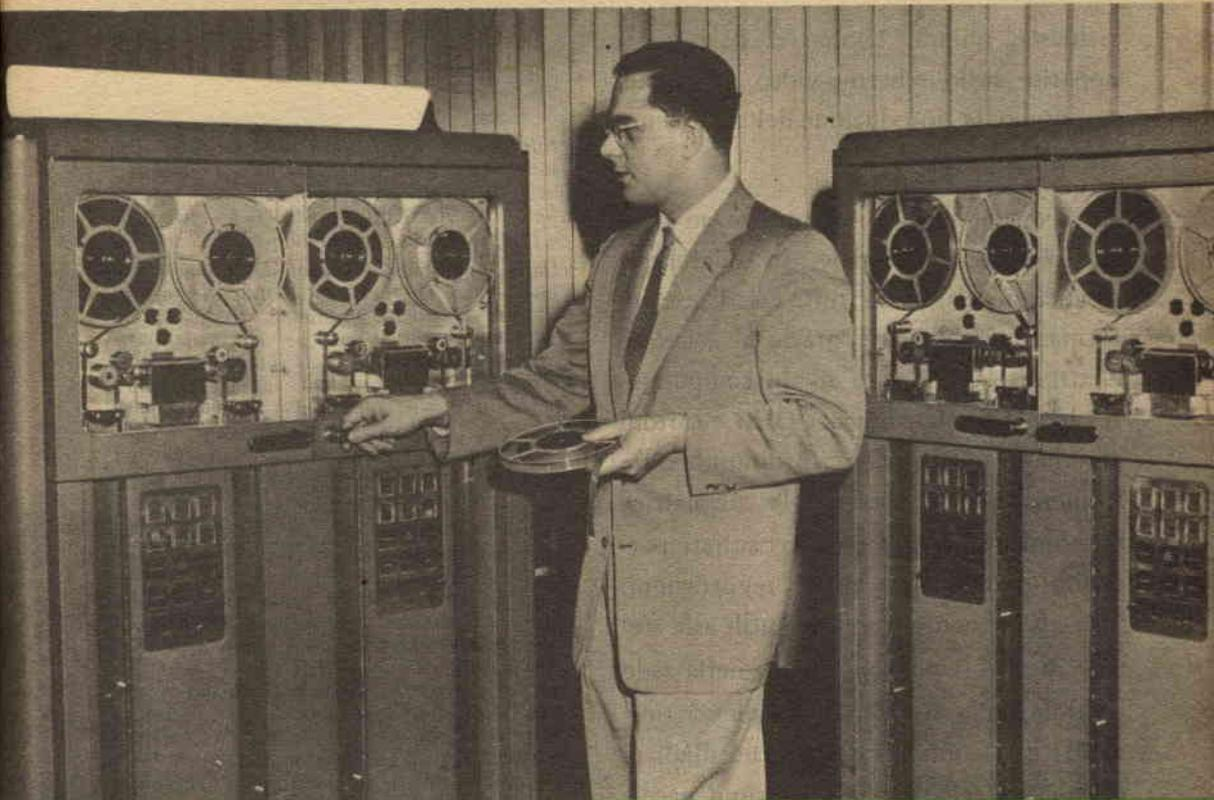
I computeri elettronici possono calcolare in pochi minuti tutti i dati necessari alla stesura di un bilancio, mentre con il sistema tradizionale questo lavoro richiedeva ore e settimane. Nella foto, un tecnico controlla gli apparecchi lettore e registratore a nastro magnetico che contengono tutte le istruzioni per la elaborazione del bilancio. I dati del bilancio vengono inseriti nel computer che automaticamente li collega fra loro.
