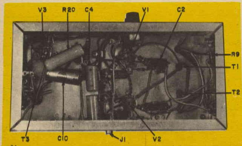
Amplificatore Anito visto di sotto. La tensione del secondario AT di T<sub>3</sub> può essere diversa da quella indicata. Regolate R 20 per ottenere circa 250 V nel punto A dello schema.
