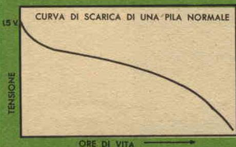
continuamente ad alte temperature, la loro vita si accorcia per l'aumento dell'azione chimica ed il prosciugarsi dell'elettrolita; le basse temperature agiscono in altro modo.
