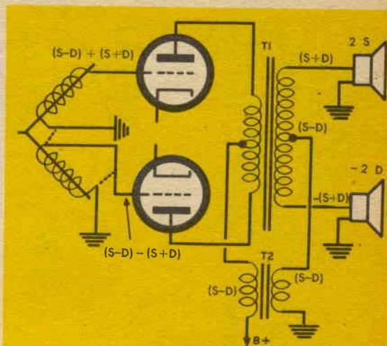
Fig. 3 - Come sorgente di segnale nel circuito simplex CBS viene usata una cartuccia stereo 45-45. La «faseatura» delle comuni cartucce è invertita. Le linee tratteggiate indicano i collegamenti normali.
