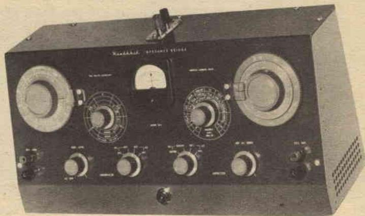
Il ponte d'impedenze illustrato qui a lato comprende un ponte di Wheatstone e parecchi altri ponti di precisione.
