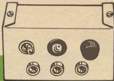
Questo apparecchio è molto comodo e può essere usato soprattutto per la prova della dispersione nei condensatori e per sostituire le batterie d'alimentazione dei ricevitori; può anche essere usato per prove di continuità, per provare elettrolitici con il metodo di sostituzione e per la rivelazione di tensioni sia alternate sia continue.
