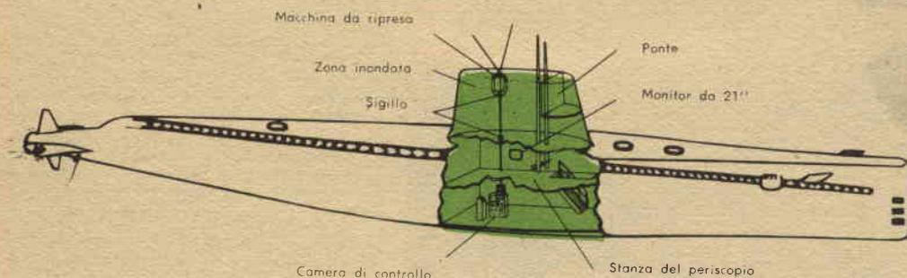
Questo schizzo illustra la disposizione della televisione a circuito chiuso nel Nautilus, in modo che capitano ed equipaggio potessero vedere il fondo della banchisa polare.
