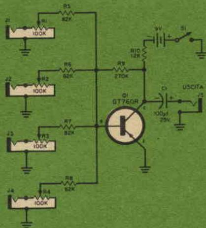
Le difficoltà che si incontrano nella costruzione di un miscelatore microfonico consistono nel rumore e nell'interazione tra i controlli. Entrambe queste difficoltà vengono superate facilmente usando un nostro vecchio amico: il transistor. Impiegando un transistor con bassa impedenza d'entrata e ponendo in serie a ciascuna entrata per microfono resistori di valore molto elevato, si può ottenere un isolamento quasi perfetto tra i diversi controlli del livello del miscelatore.
