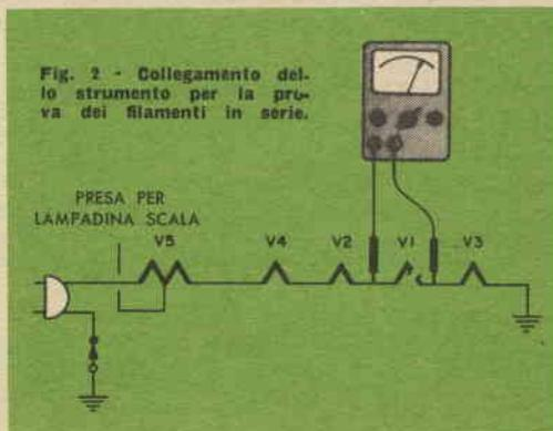
Fig. 2 - Collegamento dello strumento per la prova dei filamenti in serie.
