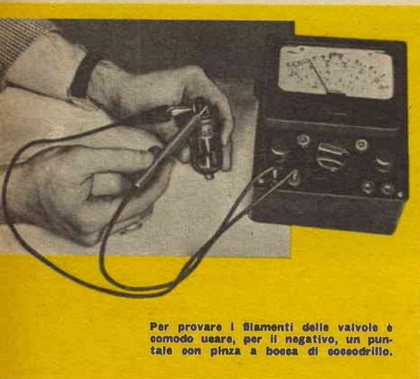
Per provare i filamenti delle valvole è comodo usare, per il negativo, un puntale con pinza a bocca di coccodrillo.
