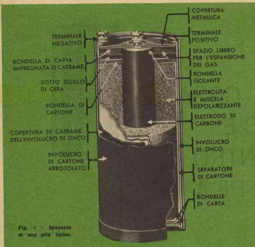
Fig. 1 - Spaccato di una pila tipica.
