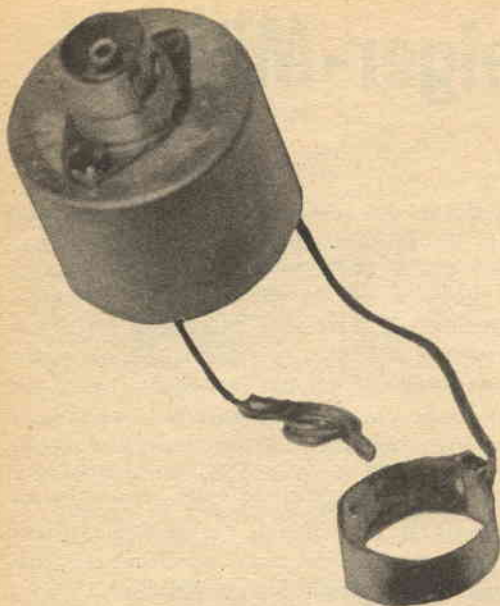
Coperchio del tubo Geiger-Müller; è visibile la presa coassiale.
