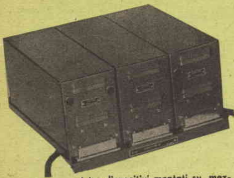
I tre dispositivi montati su mezzo mobile sono il ricevitore, l'alimentatore e il trasmettitore.
