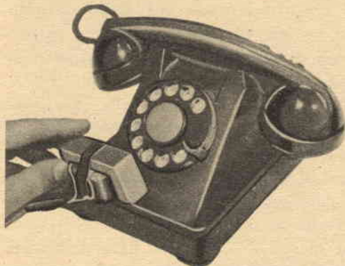
... mentre il campanello squilla spostate l'induttanza intorno all'apparecchio telefonico...
