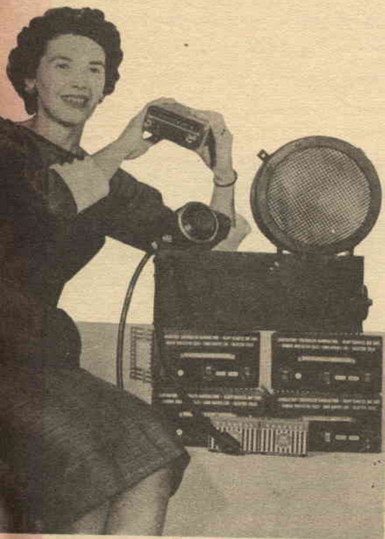
Questa ragazza tiene in mano un nuovo ricevitore (tutto a transistori) portatile per auto, che può essere usato sia in auto sia fuori. Confrontate le sue dimensioni con quelle dell'autoradio Cadillac 1929 illustrata sopra con le sue batterie d'alimentazione.
