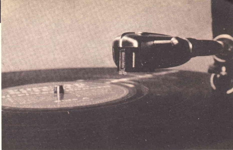
e la puntina si portano in oscillazione combinata come fanno le ruote anteriori di certe automobili ad una determinata velocità. Il suono generato è spaventosamente forte e la vibrazione colpisce la scanalatura del disco. Per toni un po' più bassi della risonanza la puntina e il braccio si muovono come un pezzo solo: non vi è nessun movimento della puntina rispetto al pick-up e non vi è perciò suono. Pertanto il pick-up non può riprodurre note molto al disotto della risonanza.
