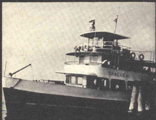
1 - L'Eraclea, una delle motonavi adibite al trasporto dei viaggiatori nel tratto di laguna San Marco-Lido. Sulla cabina di comando è visibile il radar che l'Azienda Comunale di Navigazione Lagunare sta provvedendo ad installare anche su altri natanti. Finora sono una diecina le apparecchiature radar di cui si avvalgono i trasporti pubblici di Venezia per una sempre maggiore sicurezza.
