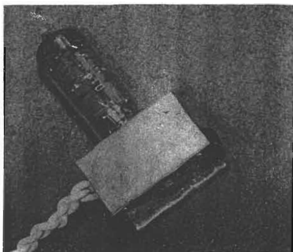
Fig. 220. - Esempio di realizzazione del preamplificatore microfonico di fig. 219.
