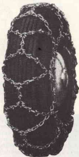
Fig. 6 - Ecco il cingolo in gomma che sostituisce la catena. Le maglie metalliche come vedesi in disegno trattengono dei settori in gomma antistrappo con incorporati speciali rampini in acciaio per renderlo adatto anche su strade ghiacciate (prezzo da L. 17.000 a 24.000 la coppia).
