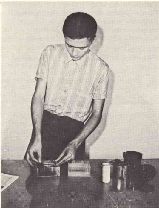
Fig. 11 - Per indebolire una negativa, le soluzioni chimiche da preparare sono due, una di color rosso ed una di color bianco. Le due soluzioni debbono essere tenute separate. Immergete la negativa nella prima soluzione per due o tre minuti, cioè fino a quando avrete constatato che l'indebolimento ha raggiunto il grado voluto.
