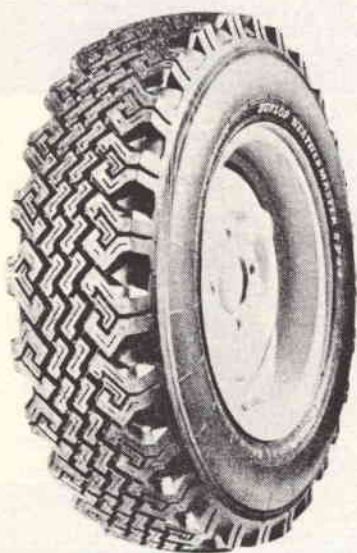
Fig. 8 - Ecco un pneumatico da neve della Dunlop usato con successo in numerosi rallies. Tale pneumatico ha una carcassa radiale ed un battistrada fortemente scolpito adatto anche per terreni con molta neve.
