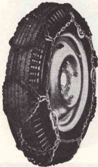
Fig. 2 - Le catene con traversini a rombo sono più costose, ma offrono una più efficace aderenza e stabilità laterale (prezzo da L. 8.000 a L. 11.000 la coppia).
