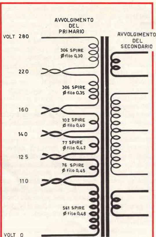
**Fig. 9 -** Se il primario del trasformatore deve disporre di più prese per poter essere adottato alle varie tensioni da 110 a 280 Volt, ricordatevi — e del resto lo rileverete dalla tabella 3 — che il diametro del filo varia a seconda della tensione di rete.
