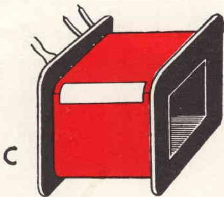
**Fig. 15-C** - Terminato uno strato, abbiate cura di isolarlo, prima di iniziare lo strato successivo, con un sottile foglio di carta tenuto fermo da un pezzetto di nastro adesivo. Tale accorgimento, oltre a garantire un isolamento perfetto tra uno strato e l'altro, consentirà di eseguire con maggior accuratezza i vari avvolgimenti.
