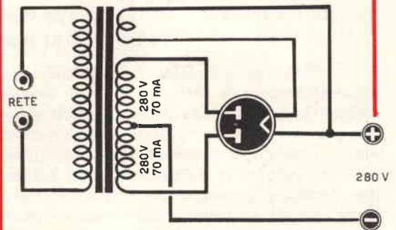
**Fig. 5-6 - Per i trasformatore che raddrizzano le due semionde (vedasi l'esempio di cui alle figure) il calcolo della potenza di tale avvolgimento si ottiene moltiplicando i Volt e gli Amper di una metà dell'avvolgimento. In fig. 6 avremo quindi  $280 \times 0,07$  Amper = 18,6 Watt per la fig. 7,  $25 \times 1 = 25$  Watt.**
