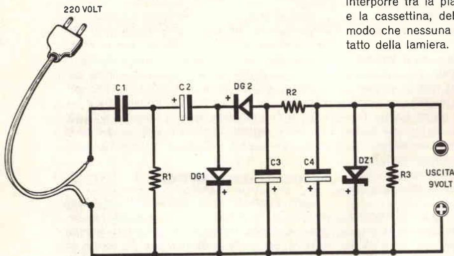
**Fig. 3 -** Tale alimentatore sarà utilissimo al dilettante per fornire tensione a progetti in fase sperimentale senza dover ricorrere alle pile che molte volte si esauriscono in breve tempo. Aggiungiamo poi che l'apparecchio non teme i cortocircuiti il che — ne converrete — non guasta proprio.
