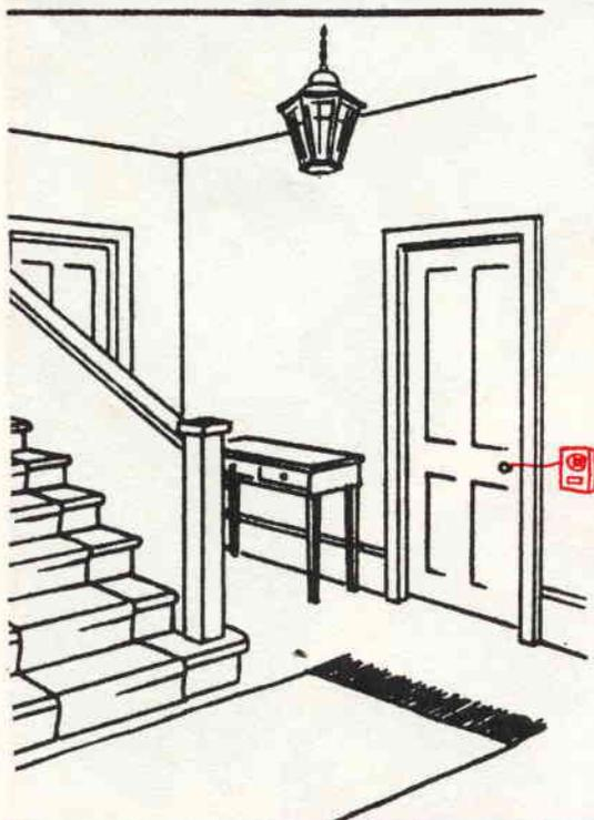
**Fig. 1 -** Collocata la sirena vicino alla porta, si provvederà a collegare la catenella alla maniglia od al battente stesso. Oltre ad essere impiegata come sistema antifurto, la sirena potrà benissimo servirsi da **SPIA** avvertendovi in maniera equivocabile quando qualcuno, magari il figliolo più piccolo, esce di casa a vostra insaputa.
