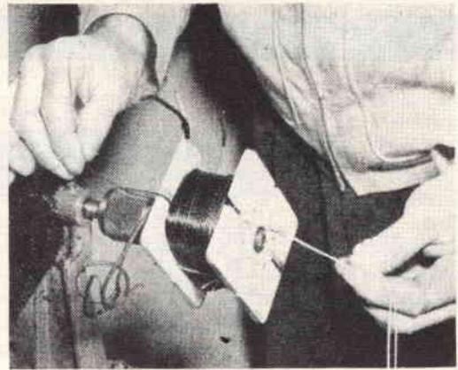
Fig. 13 - I tagli laterali delle sponde del portacartoccio — come visibile in fig. 11 — ci serviranno per fare uscire le varie prese del trasformatore. Per non incorrere in possibilità di errore, ricordatevi che i fili uscenti verranno disposti da un lato per il primario e dall'altro lato per il secondario. Sarà pure bene ricoprire i fili con guaine di diverso colore.
