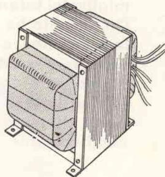
Fig. 21 - I lamierini, una volta inseriti nel cartoccio, andranno stretti con le apposite viti, per evitare che abbiano a vibrare durante il funzionamento. Prima di montare il trasformatore, collaudatelo, tenendolo per qualche ora collegato alla rete senza nessun carico. Il trasformatore se è ben calcolato o se non ha spire in cortocircuito non deve assolutamente scaldare.
