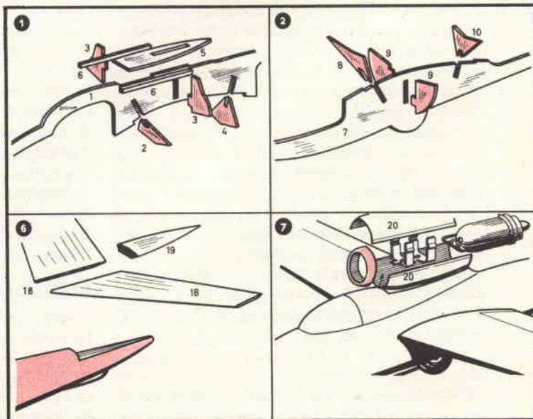
Appena ritenete che il collante che unisce i pezzi 18 al pezzo 19 secondo le indicazioni di Fig. 6, sia perfettamente secco, applicate i piani di coda alla fusoliera, facendo in modo che essi risultino perfettamente simmetrici rispetto alle ali come indicato in Fig. 10 in basso. Raccomando la massima attenzione nella realizzazione di questo particolare; ritengo che questo sia il punto più delicato di tutta la fase di montaggio.
