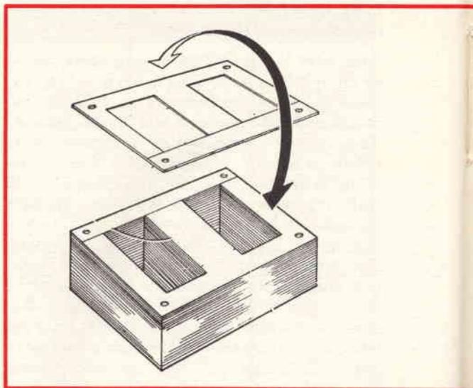
**Fig. 20 - Ricordatevi che per i trasformatori di alimentazione, i lamierini vanno inseriti intercalati e cioè uno va infilato da un lato, l'altro dal lato opposto, e così via in modo da far sì che il lamierino risulti con il lato aperto incrociato. Diversamente si creerà un traferro, capace di modificarne le caratteristiche. Basterà del resto smontare un vecchio trasformatore per rendersi conto di come questi sono infilati nel cartoccio.**
