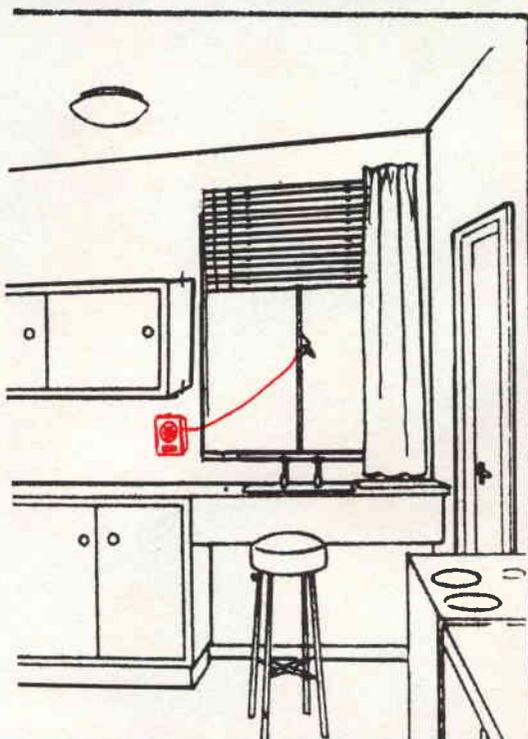
**Fig. 2 -** Poiché il sistema di funzionamento è basato su di una funicella che, sottoposta a trazione, mette in funzione un contatto jach, noi potremo benissimo applicare la sirena in qualsiasi posizione e luogo. Ad esempio alla maniglia di una finestra o anche alla stessa tapparella.
