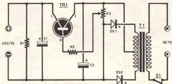
possiamo modificare la polarizzazione del transistor e cioè dare progressivamente una tensione più o meno positiva; infatti quando il cursore si troverà verso il massimo positivo, avremo all'uscita del transistor la minima tensione mentre la tensione stessa risulterà massima se il cursore sarà rivolto verso la tensione negativa.
