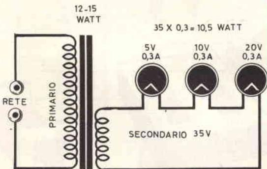
**Fig. 3 - Se un trasformatore deve servire per alimentare valvole poste in serie, si potrà calcolare la potenza in Watt moltiplicando la tensione totale per gli amper assorbiti da una sola valvola. Analogo risultato si avrà calcolando la potenza in Watt di ogni lampada aggiungendo le diverse potenze ottenute. Per valvole in serie è importante accertarsi che l'assorbimento in Amper sia perfettamente identico per tutte le valvole.**
