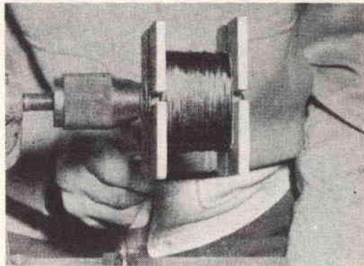
Fig. 14 - Le spire dovranno risultare perfettamente affiancate e non avvolte alla rinfusa. Un avvolgimento disordinato infatti, pur non compromettendo il funzionamento del trasformatore, vi porrà dinnanzi al problema dello spazio, poiché se i fili non sono completamente adiacenti lo spessore dell'avvolgimento aumenterà notevolmente e correte così il rischio di non poter inserire i lamierini.
