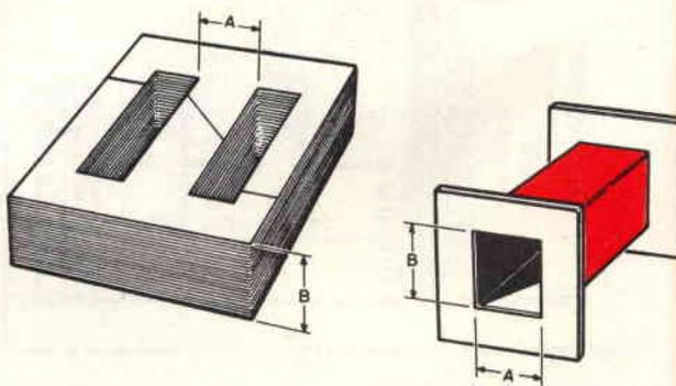
**Fig. 7 - A determinare la potenza in Watt di un trasformatore è il NUCLEO (non la grandezza del lamierino. Moltiplicando la larghezza del lamierino A per l'altezza del pacco dei lamierini B, otterremo in centimetri quadrati la SEZIONE del nucleo. In possesso di questi dati ed attenendoci alla tabella 1, sapremo quanti Watt può sopportare tale pacco di lamierini senza scaldarsi.**
