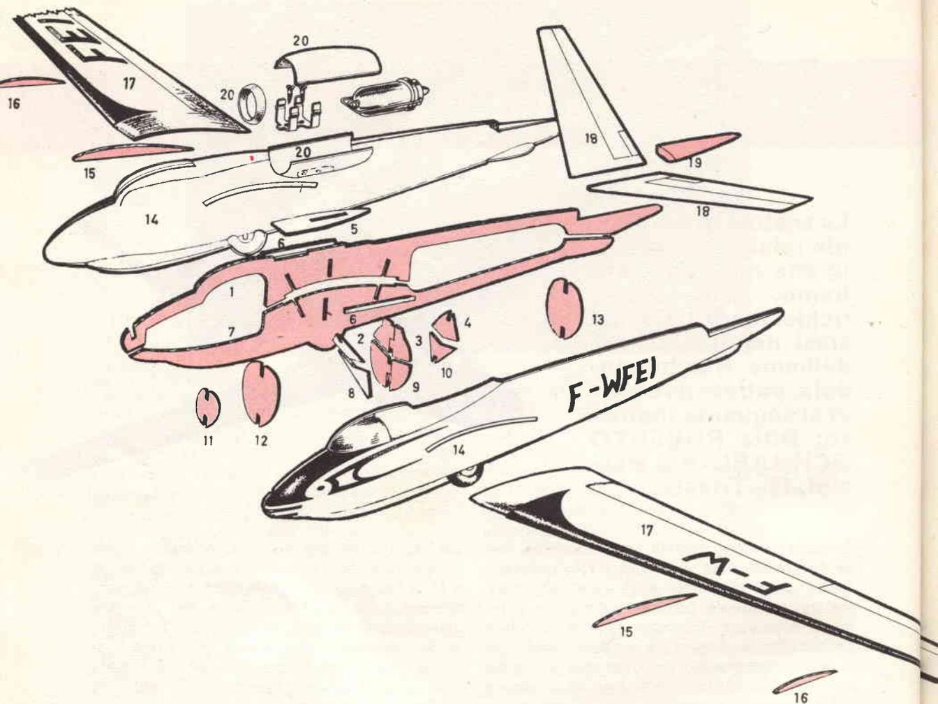
**IN ALTO**, lo spaccato del modello con l'esatta disposizione dei vari pezzi da incollare al longerone centrale.
