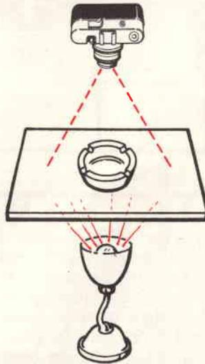
**Fig. 9 - Il portacenere saranno posti su di un piano di vetro sotto il quale verrà applicata una lampada. Sopra, la macchina fotografica collocata alla distanza minima di messa a fuoco, riprenderà il soggetto.**
