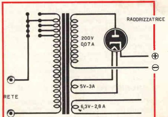
**Fig. 4 - Anche per trasformatore provvisti di alta tensione per valvole raddrizzatrici e di più avvolgimenti di bassa tensione per i filamenti, occorrerà calcolare la potenza in Watt necessaria per ogni avvolgimento ed aggiungere il tutto. Il dato ottenuto ci consentirà di stabilire esattamente le dimensioni di cui deve disporre il nucleo del trasformatore che ci necessita.**
