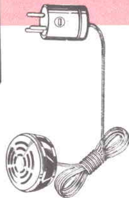
Fig. 2 - La realizzazione di questo progetto è alla portata di tutti: i pochi componenti necessari e la chiarezza dello schema pratico assicurano successo a chiunque. La calza metallica del cavo schermato va collegata alla linguetta di massa collegata al positivo della pila.
