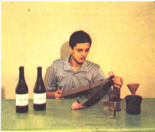
Fig. 5 - Prima di tentare con una pellicola vergine, provate a prendere dimestichezza, con un vecchio negativo, nell'eseguire l'operazione di avvolgimento. Constatato come si procede, apriremo al buio il nostro rotolo da sviluppare.
