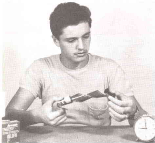
Fig. 6 - Se la vostra pellicola è del formato di 36 mm. si trova racchiusa in un cilindro metallico o di bachelite, aprite il coperchio dell'involucro che contiene la pellicola e sfilatela dal proprio interno. Questa operazione ovviamente dovrà essere condotta al buio più completo.
