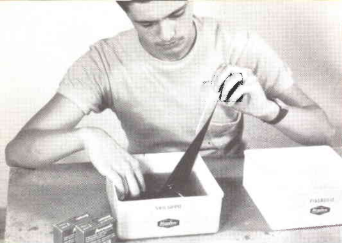
Fig. 8 - La temperatura del bagno di sviluppo è già stata controllata precedentemente (20 gradi circa) quindi ora non rimane che immergere completamente tutta la pellicola facendo attenzione che essa resti completamente coperta dalla soluzione, in modo che l'azione del bagno di sviluppo si svolga contemporaneamente su tutta la lunghezza della pellicola.
