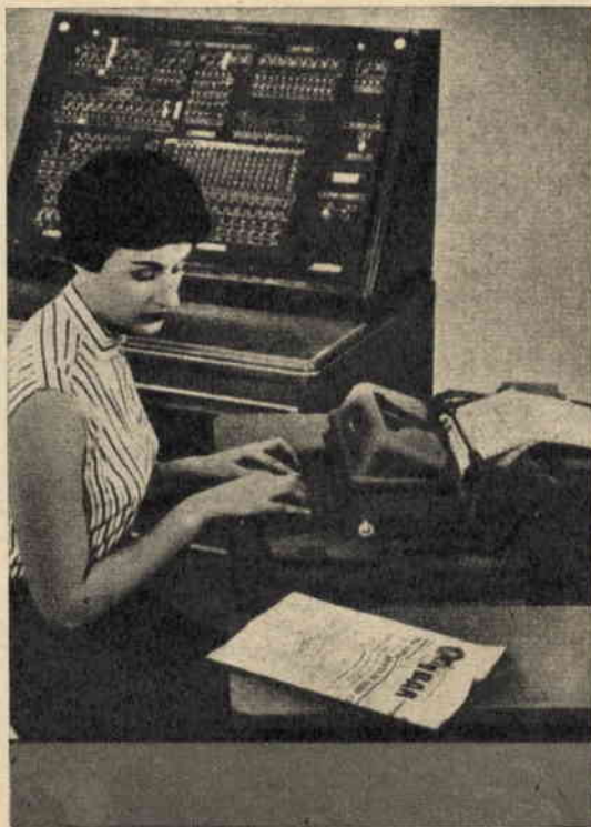
La macchina traduttrice della IBM non sa ancora leggere. Il testo russo deve quindi essere copiato da una dattilografa. La macchina da scrivere è accoppiata ad una punzonatrice automatica che trasforma il dattiloscritto in linguaggio punzonato.
