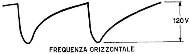
Fig. 68 - Oscillogramma relativo agli impulsi di sincronismo prelevati sulla finale di riga.
