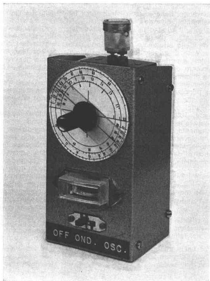
indicherà l'intensità di campo della sorgente R.F. nel punto in cui è stata misurata dal dip-meter.
