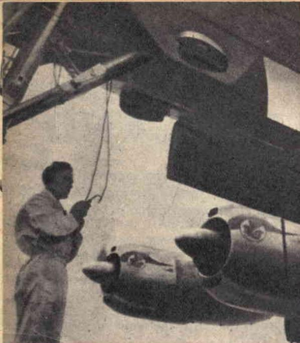
Dopo un determinato numero di ore di volo, ogni apparecchio viene sottoposto ad una accurata revisione. Ecco un tecnico che trasmette telefonicamente le sue osservazioni ai colleghi che nell'interno della carlinga esaminano i vari strumenti.
