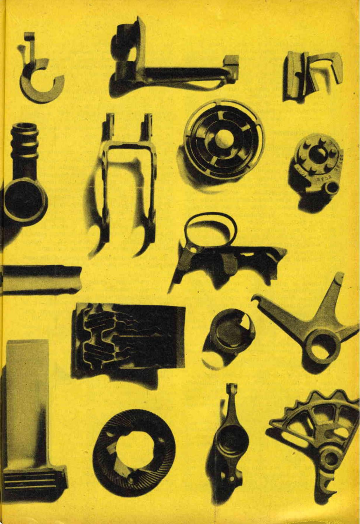
L'idea originale fu a mano a mano perfezionata, usando materiali diversi di rivestimento, vari sistemi di formatura, modelli in cera, in resine sintetiche, paraffina, e perfino in mercurio congelato, e fondendo per centrifugazione o per gravità con forni ad arco od a induzione. Tutte queste varie tecniche si adattano a diverse esigenze soprattutto in relazione al numero di pezzi da fondere o alle tolleranze di lavorazione richieste.
