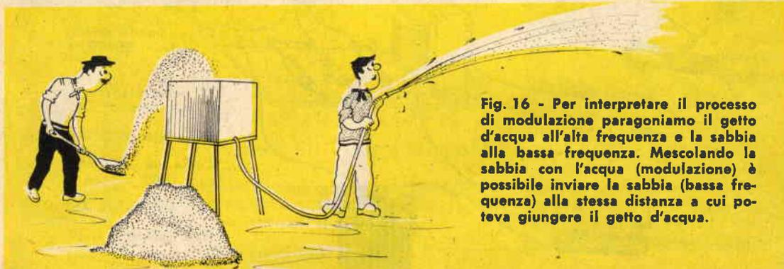
Fig. 16 - Per interpretare il processo di modulazione paragoniamo il getto d'acqua all'alta frequenza e la sabbia alla bassa frequenza. Mescolando la sabbia con l'acqua (modulazione) è possibile inviare la sabbia (bassa frequenza) alla stessa distanza a cui poteva giungere il getto d'acqua.
