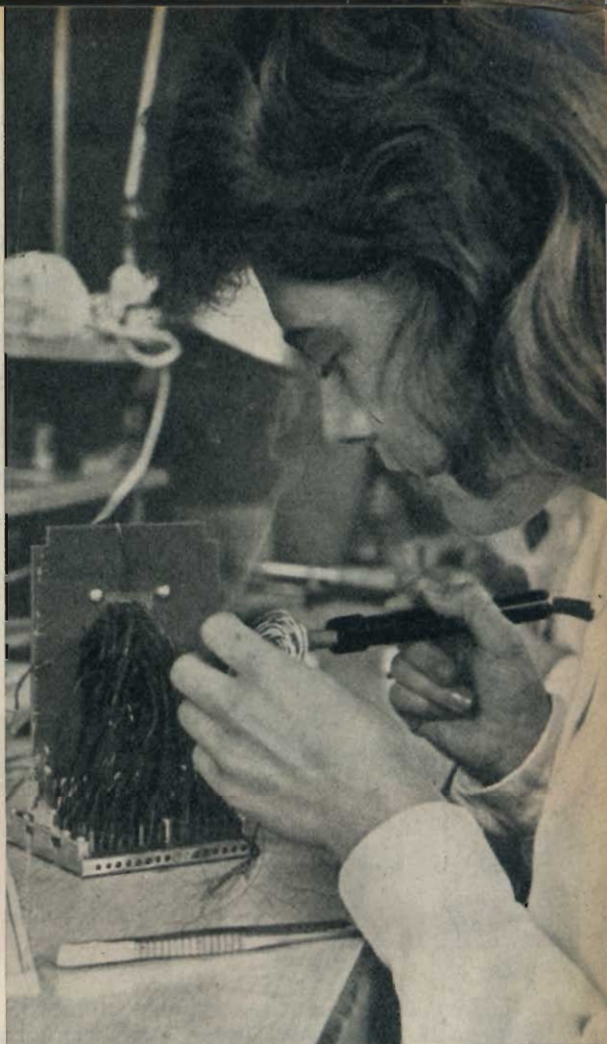
Un aspetto di una delle fasi della produzione dell'Elea: il cablaggio. Si tratta di un lavoro di precisione, della saldatura di decine e decine di fili secondo uno schema studiato nei minimi particolari.
