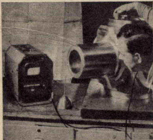
Sotto: L'attrezzatura di prova ad ultrasuoni, nell'impianto della General Electric Aircraft, garantisce il perfetto funzionamento di ogni parte dei motori.
