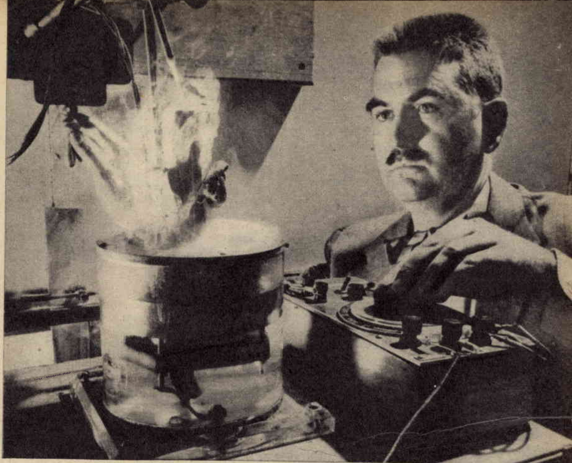
Evaporazione di un liquido dovuta agli effetti delle onde ultrasonore, durante un esperimento compiuto da un tecnico della General Electric. Questo è uno dei tanti « miracoli » dovuti agli ultrasuoni.
