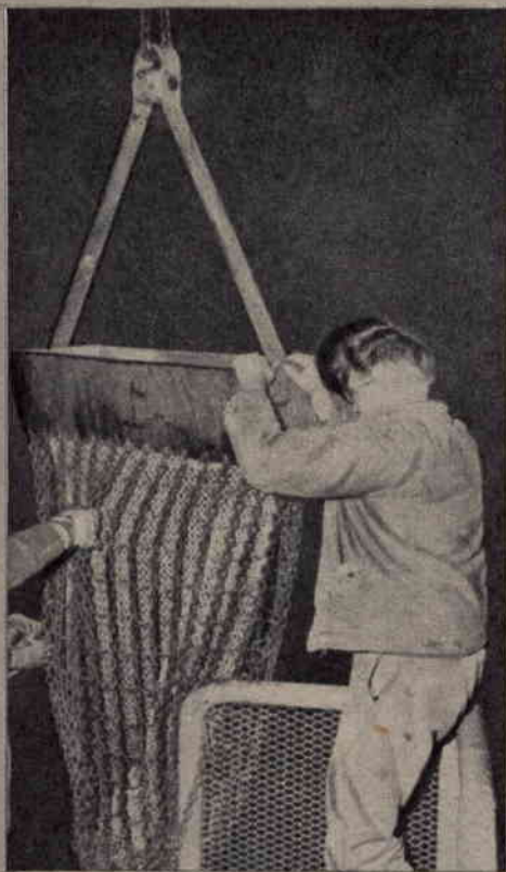
Sopra: Si procede alla raccolta dei noduli abbassando una draga sul fondo del mare. Sotto: John L. Mero, autore di un piano di sfruttamento marino, presenta campioni di noduli raccolti sul fondo del Pacifico Meridionale presso Tahiti.
