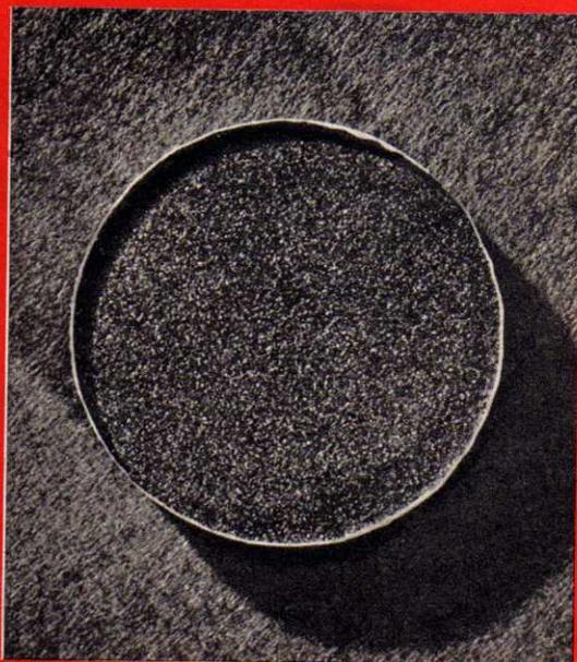
Questo campione è preparato per l'esperimento con l'apparecchio di cui alla pagina precedente. A sinistra si vede un disco di stagno estremamente puro circondato da un basso contenitore di carta. A destra, la superficie del detto disco è stata uniformemente ricoperta con polvere dell'elemento niobio.
