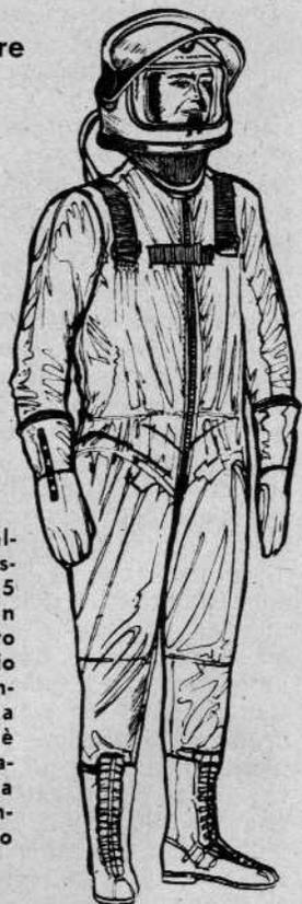
Nel disegno: Tuta totalmente pressurizzata indossata dai piloti dello X-15 della North American USAF. A destra: Protetto da una tuta di alluminio ed acciaio, il dott. Sig. Hansen si aggira nella sua « stanza lunare » da cui è stata virtualmente pompata tutta l'aria in modo da simulare le condizioni ambientali riscontrabili nello spazio.
