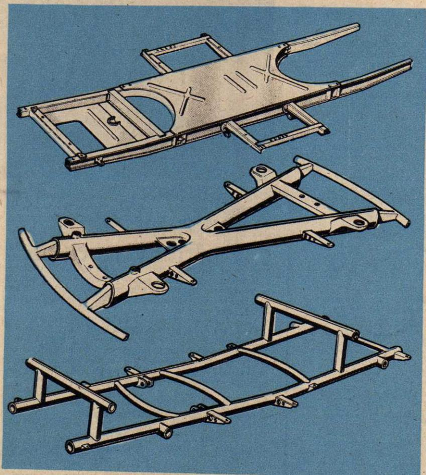
Sopra: Chassis-piattaforma della Citroen 2 CV. La leggerezza della sua struttura è stata possibile solo grazie alla particolare concezione delle sospensioni. Al centro: Chassis a X della Mercedes, realizzato con tubi ovali. Sotto: Chassis a U realizzato in robusti tubi per la vettura da competizione Gordini.
