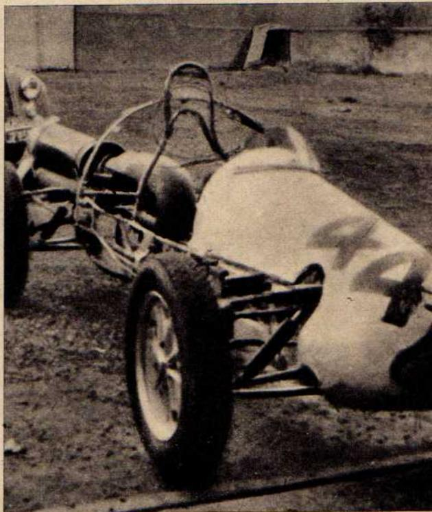
cià meccanica (ripetiamo, non c'è alcun pezzo mobile), economia di impiego ridotta a 1 kg di carburante per chilogrammo di spinta e per ora; semplificazione massima dei comandi (la Cooper con « Gambero » ha solamente pedale per l'acceleratore e per il freno), prezzo moderato, poichè il pulsoreattore, prodotto in serie, verrebbe a costare 50.000 franchi francesi.
