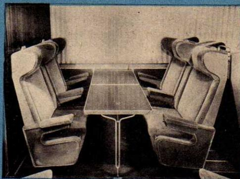
**Il treno TRANS EUROP EXPRESS (TEE.) italiano realizzato dalla Breda. Esso è costituito da due elementi entrambi motori, accoppiati con intercomunicazione ed integrantisi nel complesso dei vari servizi. Ciascuno dei due elementi del convoglio è munito di motore Diesel a 4 tempi Breda a 12 cilindri orizzontali per 490 cv a 1500 giri/min. Le poltrone del TEE. (vedi particolare) ampie e comode, hanno cuscini regolabili su tre diverse posizioni, a volontà del viaggiatore.**
