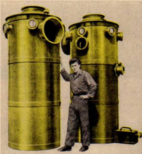
La resistenza alla corrosione è una delle qualità che fa preferire le sostanze plastiche nella costruzione degli impianti chimici. Ecco due torri di reazione in plastica.
