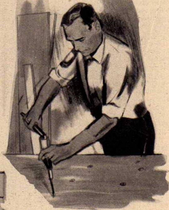
Per avvitarre più rapidamente un certo numero di viti, ci si può servire dello zoccolo d'una chiave per dadi. Se ne sceglie uno di dimensioni adatte e vi si inserisce un cacciavite normale con manico di materiale plastico scanalato o di legno e poi si fissa il dado al cricco di guida.
