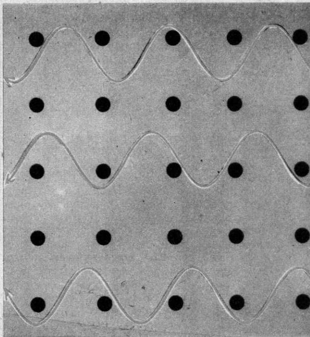
Gli elettroni in stato di superconduttività (linee ondulate, nella figura superiore) si dispongono ordinatamente attorno agli atomi (cerchietti neri) di un cristallo. Gli elettroni conduttori ordinari (figura in basso) sono invece deviati dagli atomi.
