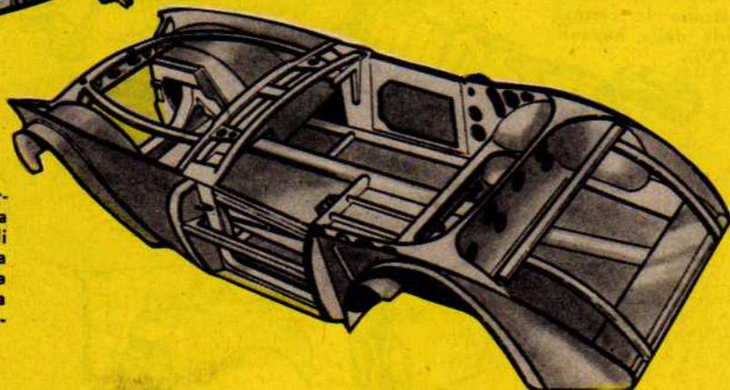
Una complessa carrozzeria a struttura rigida, composta di elementi di lamiera di acciaio imbutita e saldata, per una vettura spider Swallow-Doretti.
