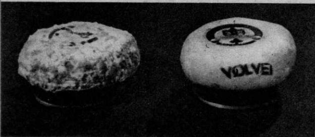
**Arresto dello sviluppo di muffe sul formaggio, grazie all'azione dell'ultravioletto. Il formaggio di sinistra non è stato sottoposto ad irraggiamento; quello di destra è stato irradiato per 16 ore su 24 con un'intensità di appena  $0,3 \mu w/cm^2$ . e rivoltato ogni giorno. Su di esso vi è assenza totale di muffa.**
