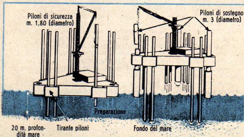
Come nasce un'isola d'acciaio. Piloni d'emergenza sostengono la piattaforma sopra il livello d'acqua, mentre vengono montati e saldati i piloni di sostegno. Quindi la piattaforma è rimorchiata nel luogo prestabilito. Mentre si esegue l'affondamento e il fissaggio dei 3 piloni di sostegno la piattaforma è sostenuta da 12 piloni provvisori, che poi vengono estratti.
