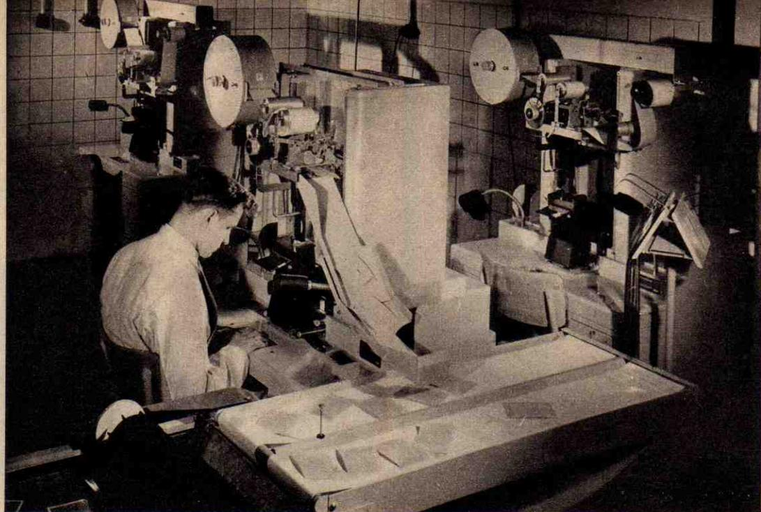
**Una macchina stampatrice. Le copie provenienti da un rullo di carta, continuo, vengono tagliate e successivamente sviluppate. Apparecchiature elettroniche provvedono a dare tempi di esposizione accuratamente calcolati per i diversi tipi di negativi.**
