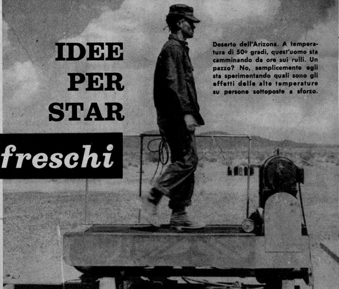
Deserto dell'Arizona. A temperatura di 50° gradi, quest'uomo sta camminando da ore sui rulli. Un pazzo? No, semplicemente egli sta sperimentando quali sono gli effetti delle alte temperature su persone sottoposte a sforzo.
