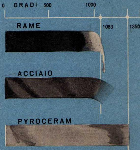
Pochi sono i metalli leggeri che resistono alle alte temperature. Mentre il rame si fonde a 1083° e l'acciaio alla stessa temperatura incomincia a deformarsi, il «Pyroceram» resiste sino a 1350°.
