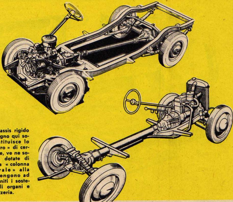
Se lo chassis rigido (nel disegno qui sopra) costituisce lo «scheletro» di certe vetture, ve ne sono altre dotate di una vera «colonna vertebrale» alla quale vengono ad essere uniti i sostegni degli organi e la carrozzeria.
