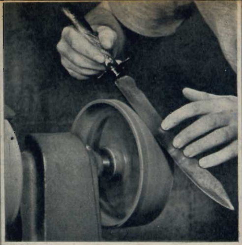
Un tamburo di smerigliatrice, coperto con tela impregnata di smeriglio fine conferisce un buon taglio a quasi ogni utensile. Il tamburo visibile nella fotografia è di alluminio fuso.
