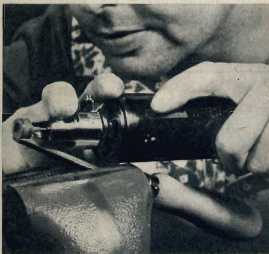
Questa piccola ruota di mola azionata da un motore veloce serve per affilare utensili di profilo irregolare. Serve anche per togliere le intaccature dall'orlo curvo di teste di fresa e simili.
