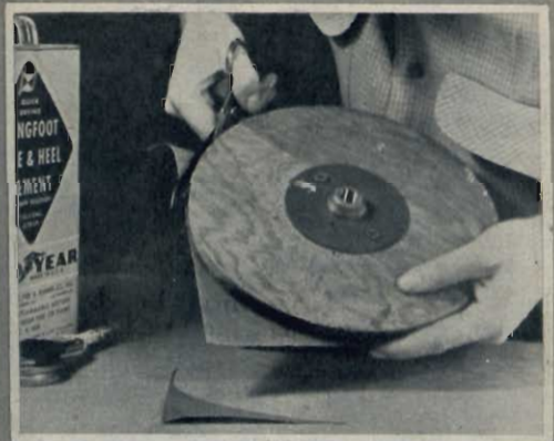
La stoffa abrasiva rende facile e semplice l'affilatura che viene eseguita servendosi di un motore. Per far questo cementate una stoffa ad ossido di alluminio su un disco di legno.
