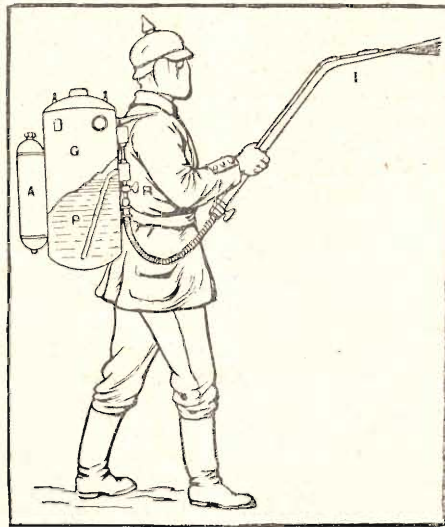
Fig. 5. — Tipo quasi abbandonato di lanciafiamme portatile, a pressione di gas e ad accensione dall'esterno: A, riserva di anidride carbonica; G, anidride carbonica esercitante la pressione sul liquido P; R, valvola; I, accenditore del getto liquido; J, fiamma.
