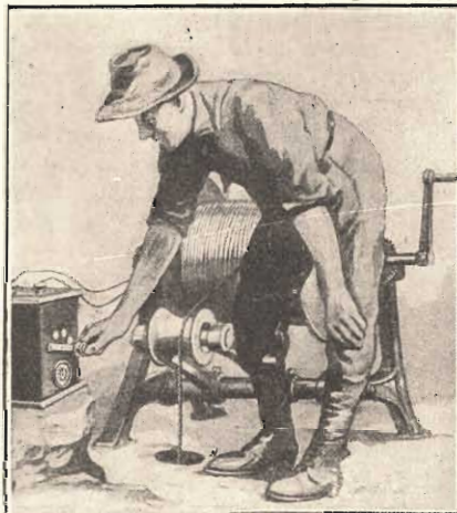
Interno dell'apparecchio registratore delle deviazioni, in atto di funzionare: A) foro praticato dalla sonda e di cui si deve misurare l'obliquità; B) filo doppio di comunicazione elettrica e di sostegno; C) lampadina; D) lente concava; E) disco di vetro col reticolato; F) giunto per accorciare lo strumento; G) lente concava; H) raggi di luce; I) pallina mobile di bronzo per generare l'ombra; K) filo a piombo che sostituisce la pallina, in un modello più recente dell'apparecchio; L) dischi di carta fotografica. — In alto si vede il verricello, col filo elettrico che serve per accendere la lampadina nell'interno dell'apparecchio registratore e per sostenerlo.
