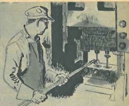
Le valvole lavorano ad elevate temperature e sono perciò ricavate con stampi da steel d'acciaio al Cr-Si riscaldato al rosso. Le molle che assicurano la chiusura delle valvole sono di filo d'acciaio termotrattato.
