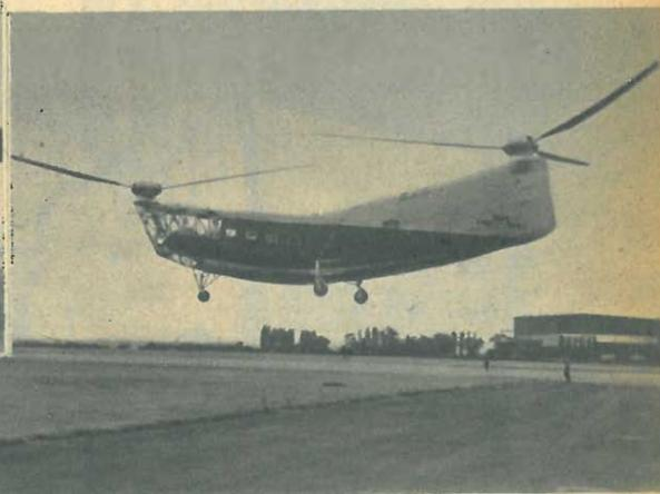
« in folle » quando i giri del motore sono insufficienti alla sostentazione. Inoltre le pale del rotore debbono essere libere d'invertire il loro passo in maniera di assicurare una certa sostentazione quando siano poste in autorotazione. Solo dopo aver risolto tutti questi tutt'altro che semplici problemi, si è potuto parlare di elicotteri che effettivamente rispondessero alle necessità pratiche.
