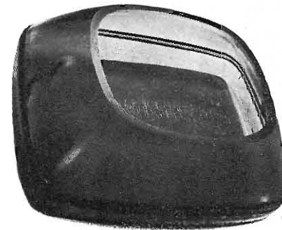
Fig. 4 - Sezione di un tubo CFT mostrante la griglia a fili paralleli (Foto CSF).
