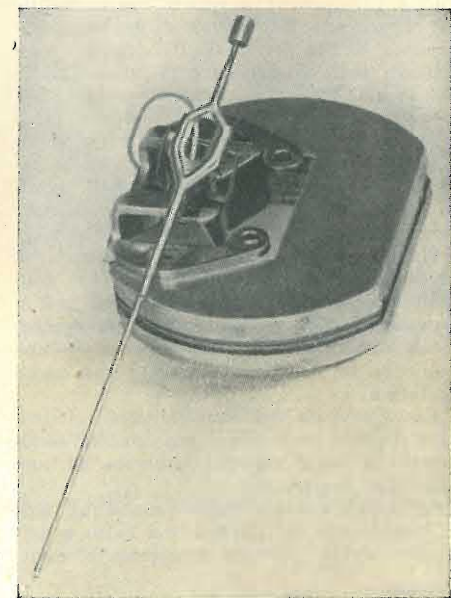
Fig. 3. - Registratore a scrittura diretta ad inchiostro. (Realizzazione I.C.E. di Milano).
