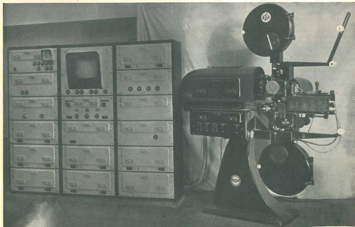
Fig. 3. - Analizzatore « flying spot » per films cinematografici, di costruzione francese.
