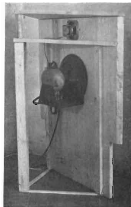
Sotto: Fig. 3. - Vista posteriore del mobile d'angolo a cassa armonica con disposizione dei due altoparlanti.
