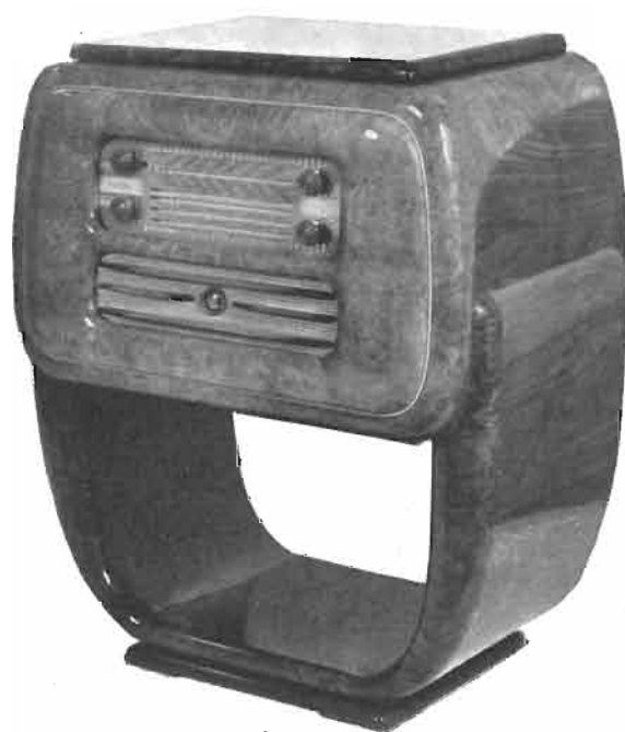
Mod. 560 RGL - Supereterodina a 6 valvole - Cinque gamme d'onda, 2 medie e 3 corte - 2 altoparlanti - Grande scala a specchio - Mobile in radica tipo extra lusso - Occhio elettrico di sintonia - Potenza di uscita 5,8 Watt con 10% di distorsione - Potenza media 3 Watt con 1,8% di distorsione - Ingombro: 80x75x40 - Complesso fonografico a 3 velocità LESA.
