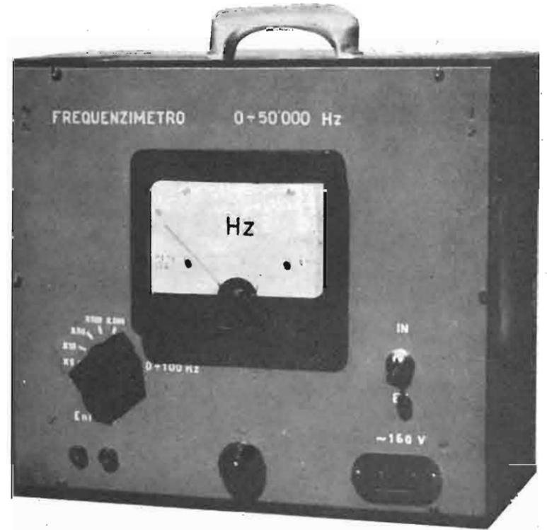
Fig. 1. - Frequenzimetro per audio ed ultra-audio frequenze, a lettura diretta su milliamperometro.
