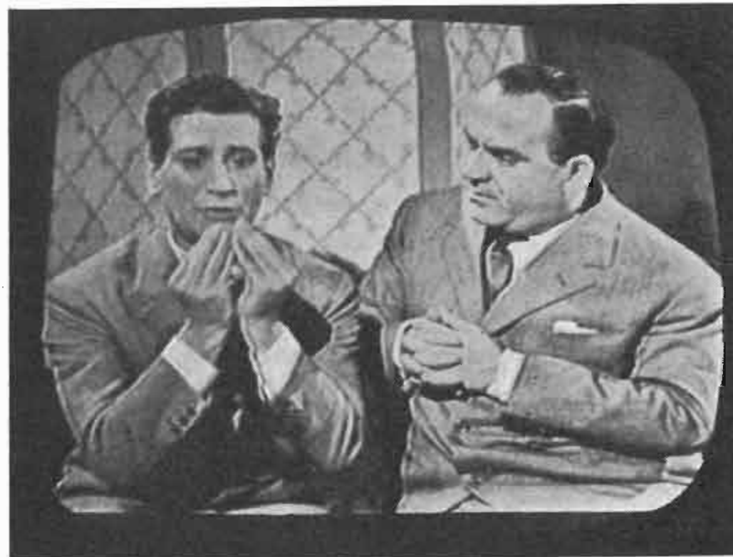
Fig. 19. - Effetto «fantasma» causato dalla ricezione di un segnale riflesso da un ostacolo.
