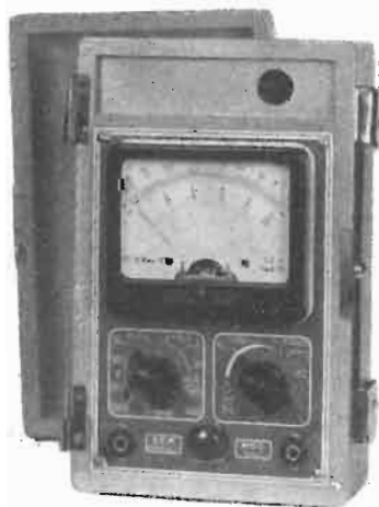
ANALIZZATORE Mod. 601/1 10.000 OHM/VOLT cc. e ca. 5 portate voltmetriche cc. e ca. da 10 e 1.000 Volt - 5 Miliampereometriche da 100 microamper a 500 miliamper cc. - Ohmetro in 3 scale da 1 ohm a 5 Megaohm
