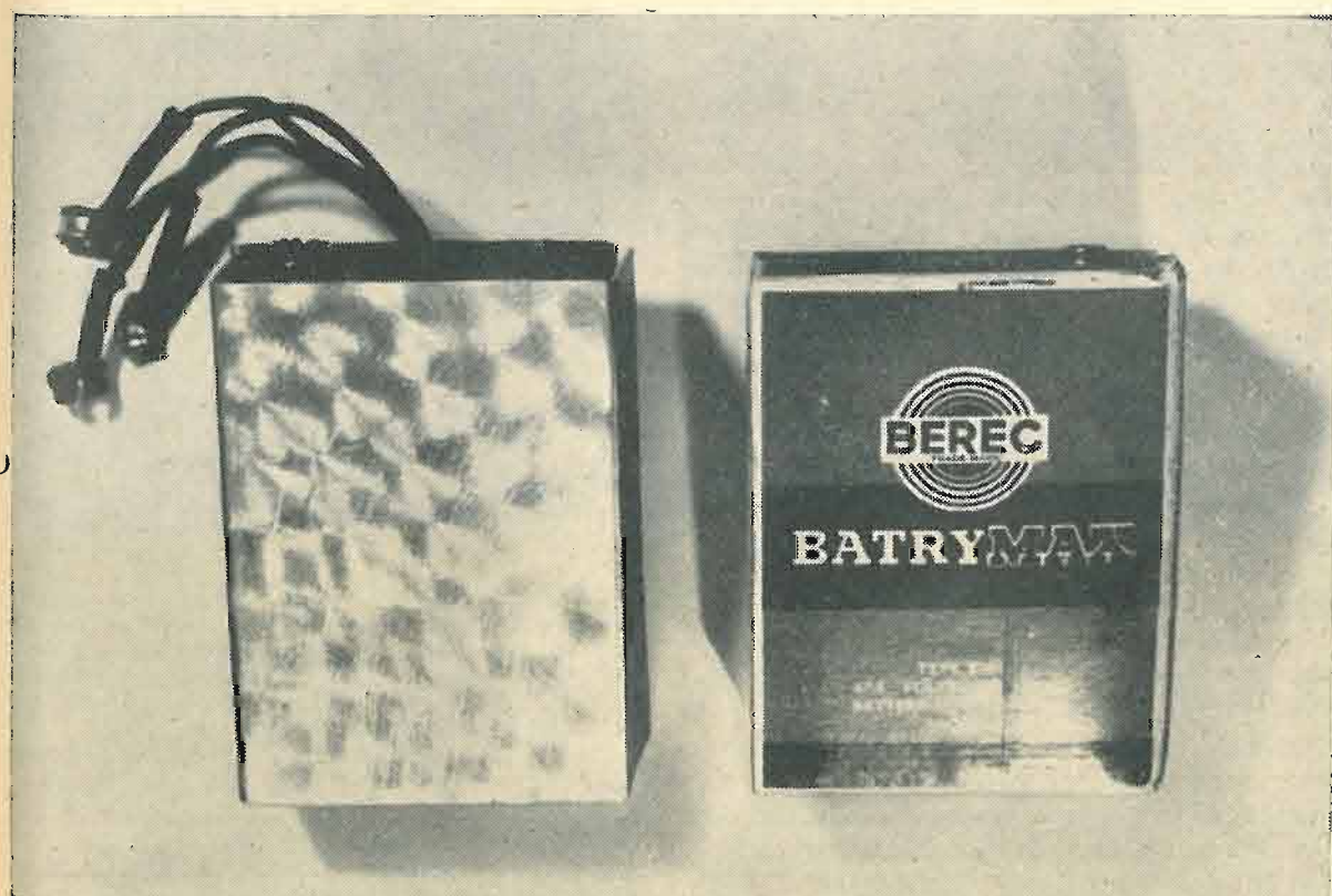
Fig. 4 e 5 - Alimentatore a c.a. intercambiabile con la batteria anodica.
