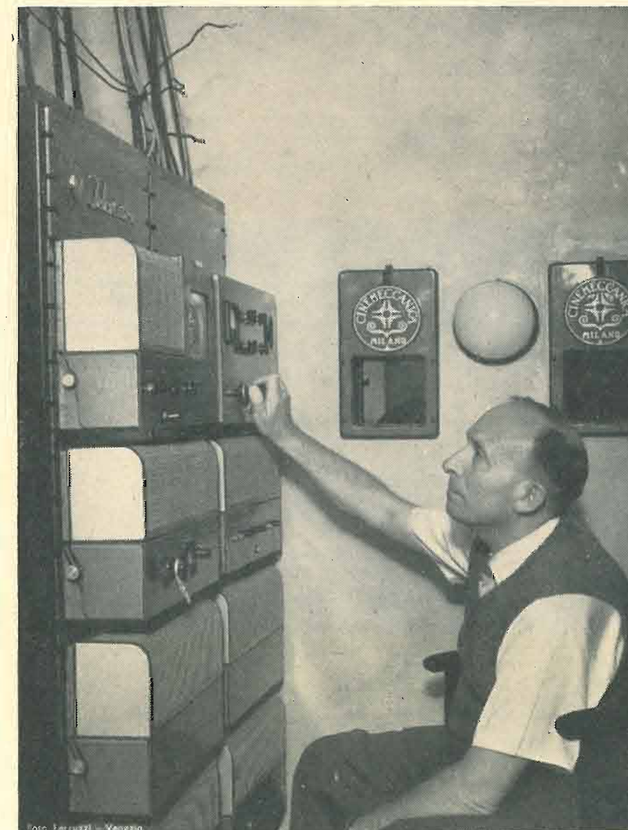
I pannelli di comando del proiettore televisivo PT100 della R.C.A. installato al Cinema Rossini a Venezia.
