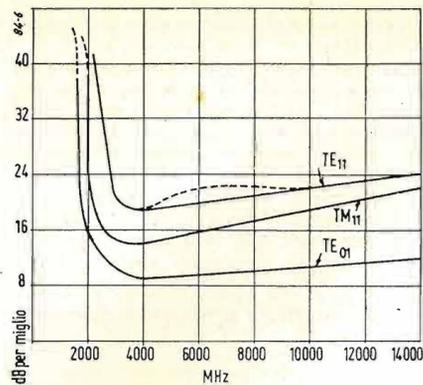
Fig. 5. - Attenuazione per miglio di guide d'onda quadrate.
