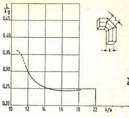
Fig. 6. - Raccordo per guida d'onda quadrata. Dimensionamento.
