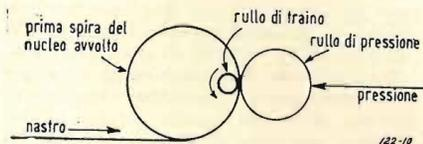
Fig. 5. - Sistema meccanico di avvolgimento dei nuclei.
