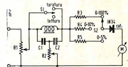
Fig. 1. - Misuratore del fattore di distorsione. Distinta del materiale impiegato:  $R_1 = 1000$  ohm, a filo;  $R_2 = 1$  M, a carbone;  $R_3 = 40.000$  ohm, 0,5 W;  $R_4 = 3000$  ohm, 0,5 W;  $R_5 = 600$  ohm, 0,5 W;  $Z_1 =$  impedenza 8 H, 200 ohm;  $C_1 = 0,05$  microF, 1500 V;  $C_2 = 0,05$  microF, 1500 V;  $S_1 =$  Commutatore 1 via, 3 posizioni;  $S_2 =$  Commutatore 1 via, 3 posizioni;  $M =$  Microamperometro a scala ampia, 0-100 microA.
