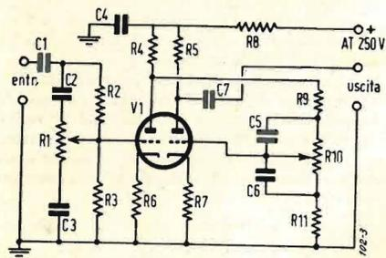
Fig. 1. - Schema elettrico dello stadio regolatore di tono.
