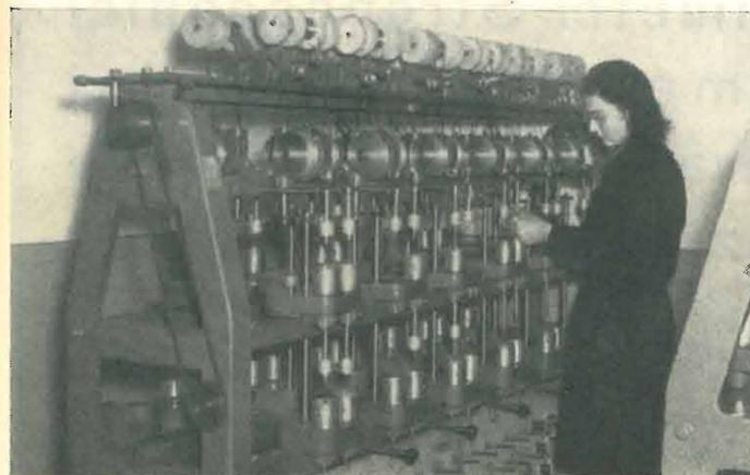
Una attrezzatura moderna e controlli rigorosi durante la lavorazione, nonché l'impiego di materiali di alta qualità, sono i presupposti per una produzione che possa competere con la concorrenza del mercato. Nella foto, una macchina spiraletrice a una e due coperture seta per la fabbricazione del filo Litz nel nuovo stabilimento della CESA (Conduttori Elettrici Speciali Affini) in Via Conte Verde a Milano. Vedere altri particolari a pagina 98.
