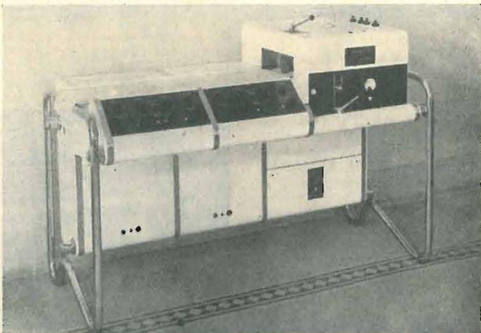
Elettrocardiografo a penne multiple, Mod. R.35e a 4 registrazioni contemporanee, delle Officine Galileo. Caratteristiche principali: commutatore a 10 derivazioni (come per il Mod. R.35b), stabilizzatore elettronico e neutralizzatore come per il modello suddetto, otto velocità di scorrimento della carta in due serie distinte.
