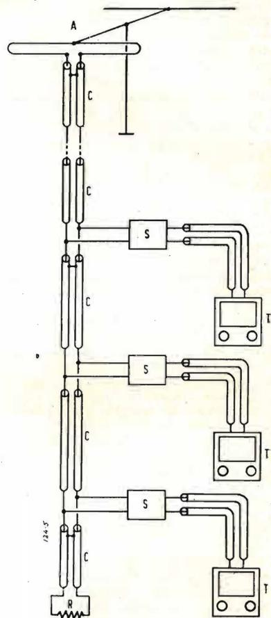
Fig. 3. - Schema di un impianto di antenna centralizzata per l'alimentazione di parecchi televisori ai vari piani di un edificio. A = antenna; C = cavo coassiale binato; S = scatole di derivazione; T = televisori.
