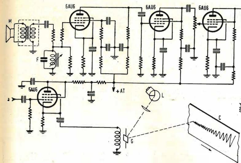
Fig. 2. - Schema di riverberometro a registrazione.
