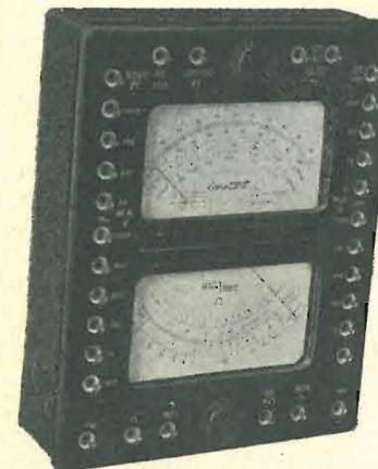
**Combinat - Complesso Analizzatore Oscillatore portatile**
