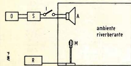
Fig. 1. - Disposizione per la misura riverberometrica.
