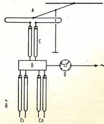
Fig. 5. - Schema di un impianto di antenna centralizzata con amplificatore-distributore a parecchie uscite. A = antenna; D = amplificatore-distributore; O = interruttore orario; C1, C2 = linee di collegamento ai televisori.
