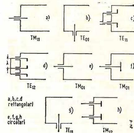
Fig. 3. - Eccitazione guide d'onda.
