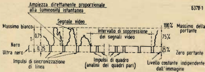
Fig. 1. - Portante modulata positivamente in ampiezza.
