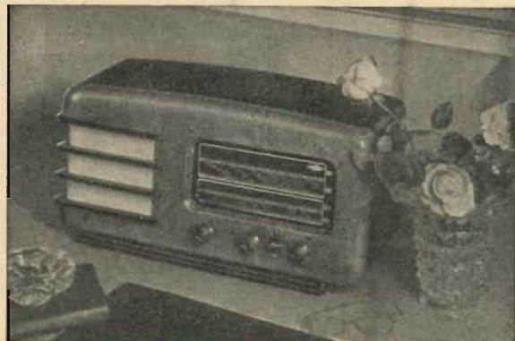
MOD. 541 5 valvole, 4 gamme, sintonia a permeabilità variabile
