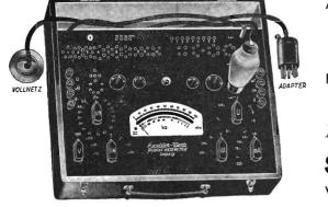
Analizzatore Provavalvole "KATHOMETER,
