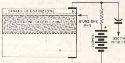
Principio di funzionamento di un rivelatore di radiazioni radioattive a semiconduttori.
