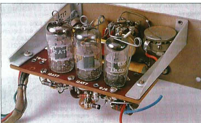
A sinistra: uno dei 4 moduli che compongono un oscilloscopio a valvole. I tubi sono accoppiati col metodo dell'inseguitore di catodo. Sotto: le 3 configurazioni di collegamento esaminate nell'articolo.
