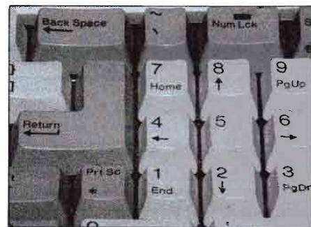
Particolare della tastiera: parte numerica; la parte alfabetica è invece più o meno simile a quella di una macchina da scrivere.
