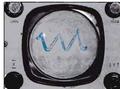
Traccia dell'onda triangolare, vista all'oscilloscopio, generata dal dispositivo proposto.
