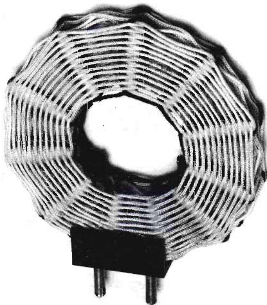
Fig. 9 - La bobina a nido d'api, montata sul ricevitore a cristallo di galena descritto nel testo, difficilmente è reperibile presso i negozi di rivendita di materiali radioelettrici. La si può invece acquistare sui mercati specializzati, ma saltuari, appositamente organizzati per gli appassionati di elettronica.
