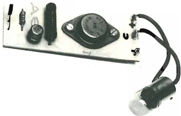
Fig. 14 - Montaggio del dispositivo di pilotaggio, tramite magnete permanente, di carico elettrico resistivo o induttivo di potenza non superiore ai 48 W.
