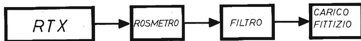
Fig. 4 - Le operazioni di taratura del filtro passa banda si eseguono, dopo aver composto la catena radioelettrica qui riportata, intervenendo sui due compensatori C2 - C5 ed eventualmente sulla spaziatura delle spire delle bobine.
