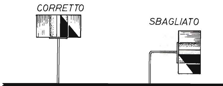
Fig. 10 - Il radiatore è un componente che deve essere montato sempre con le alette in posizione verticale, come illustrato sulla sinistra del disegno, allo scopo di favorire i moti convettivi dell'aria.
