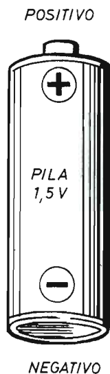
Fig. 3 - Tipico modello di pila a torcia da 1,5 V. Il morsetto positivo è rappresentato dall'elettrodo centrale, quello negativo dall'involucro metallico esterno.
