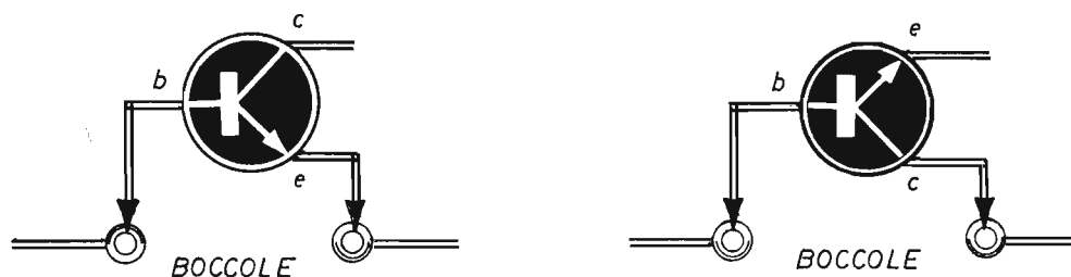
Fig. 6 - Questi due esempi di prova delle giunzioni interne di un transistor si riferiscono ad un modello di tipo NPN. A sinistra è sotto esame la giunzione base-emittore, a destra quella di base-collettore.
