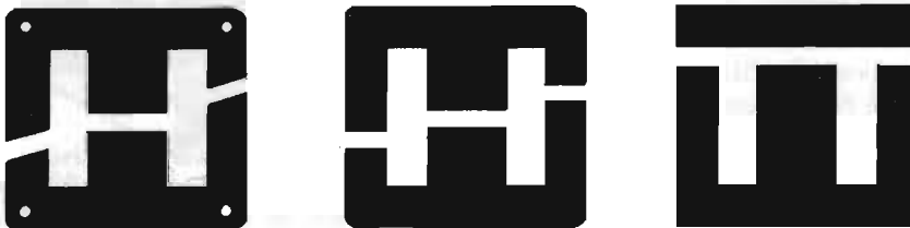
Fig. 12 - I lamierini al ferro-silicio, destinati a comporre il pacco lamellare dei trasformatori, possono essere diversamente costruiti, a seconda delle necessità di ridurre le dispersioni elettromagnetiche.
