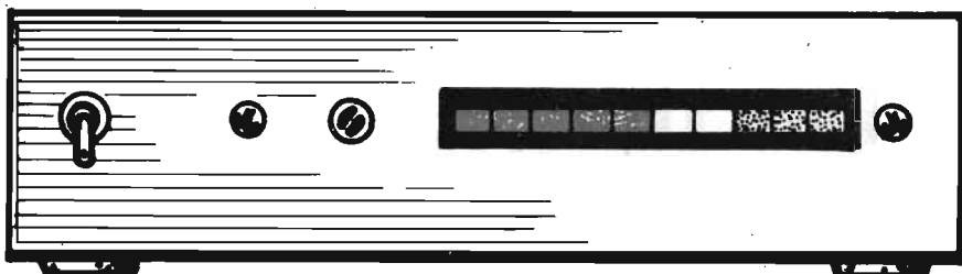
Fig. 5 - Sul pannello frontale del dispositivo di controllo della modulazione sono presenti: l'interruttore, il foro per la regolazione del trimmer presente sul circuito della barra e, infine, la barra luminosa.
