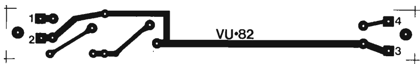
Fig. 9 - Disegno in grandezza naturale del circuito stampato sul quale si realizza il semplice piano costruttivo della barra luminosa.
