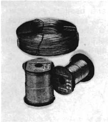
Fig. 2 - Il filo-stagno è il materiale di saldatura universalmente adottato nel mondo dell'elettronica. Esso viene venduto in blocchetti di varie dimensioni ed è lucente e flessibile. In pratica si tratta di un tubicino, nella cui cavità interna è contenuto il disossidante inerte, cioè non corrosivo.
