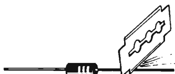
Fig. 7 - Quando si deve saldare il terminale di un componente elettronico, occorre provvedere alla pulizia perfetta del terminale stesso; a tale scopo ci si può servire di una lametta da barba, con la quale si raschia il conduttore sino a porre in evidenza la sua originale lucentezza metallica.
