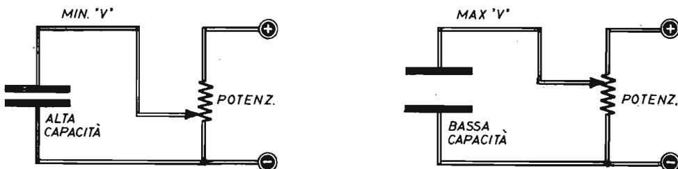
Fig. 6 - Il potenziometro R5 regola la sintonia del ricevitore facendo variare la tensione inversa applicata agli elettrodi del diodo varicap, qui raffigurato come un normale condensatore. In corrispondenza del valore minimo di tensione si raggiunge il massimo valore capacitivo. Viceversa, alla massima tensione corrisponde la minima capacità (schema a destra).
