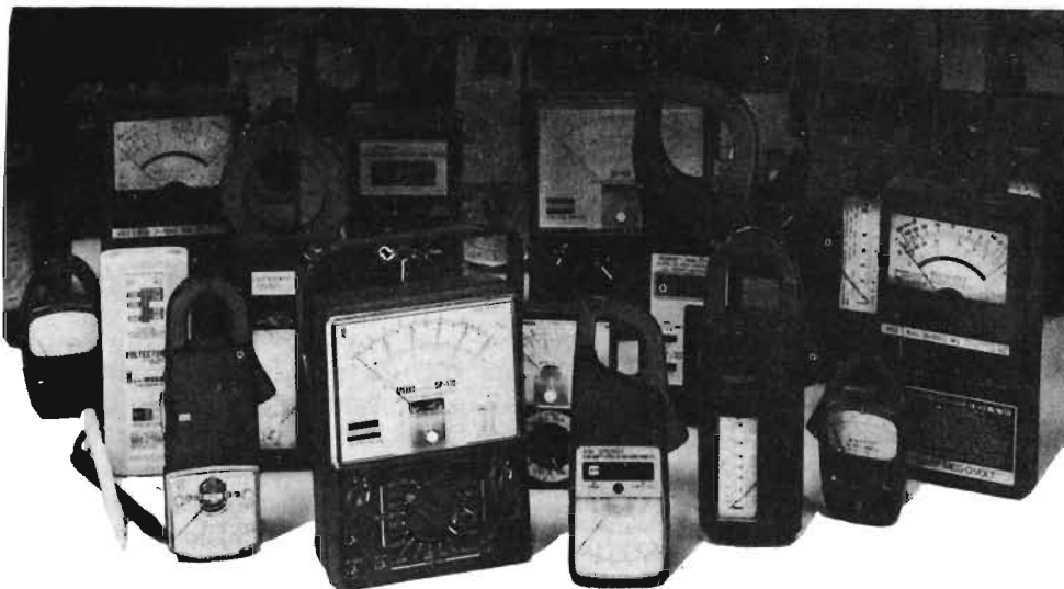
Fig. 1 - Esiste attualmente in commercio una grande quantità di tester, per uso dilettantistico, per professionisti elettronici e per elettricisti. In questa panoramica predominano gli strumenti a pinza, adatti per misurare le correnti di forte intensità senza interrompere i cavi conduttori; si tratta di tester usati principalmente nell'industria elettrica e in taluni settori dell'artigianato.
