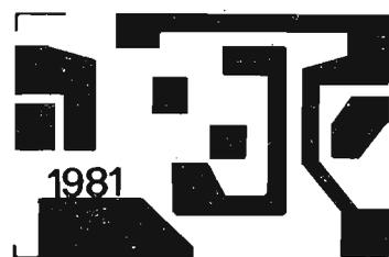
Fig. 7 - Disegno del circuito stampato, in grandezza reale (scala unitaria), visto dalla parte delle piste di rame.
