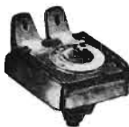
Fig. 10 - Compensatore di tipo a pressione. Le variazioni capacitive si raggiungono intervenendo con un cacciavite sulla testa della piccola vite centrale.
