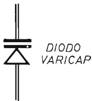
Fig. 9 - Simbolo elettrico di un diodo varicap.
