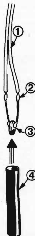
Fig. 6 - Interpretiamo con questo disegno il sistema più adatto per ottenere un perfetto isolamento, nella massa d'acqua, dell'elemento sensore. Gli elementi evidenziati sono: il cavetto bifilare (1), le saldature a stagno fra gli elettrodi della resistenza NTC e il cavetto bifilare (2), la resistenza NTC (3) e la guaina termorestringente (4). Una volta realizzato questo particolare tipo di montaggio, la guaina termorestringente, che in pratica altro non è che un tubetto di plastica, deve essere avvicinata ad una fiamma; soltanto così essa potrà opportunamente deformarsi, restringersi ed aderire alla perfezione agli elementi incorporati.
