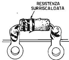
**Fig. 1 - Quando in sede di dissaldatura dei terminali di una resistenza si induglia troppo con il saldatore, oppure quando si fa uso di un saldatore di notevole potenza elettrica, si rischia di far « bollire » il componente, danneggiandolo irrimediabilmente.**
