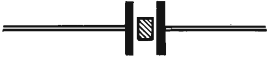
Fig. 1 - Anche il quarzo, così come avviene per tutti i componenti elettronici, viene rappresentato, negli schemi teorici, mediante un simbolo elettrico: quello qui riportato.
