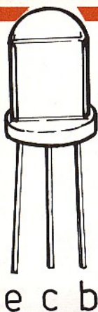
Fig. 5 - Disposizione degli elettrodi di emittore-collettore-base nei due transistor TR1 e TR2.
